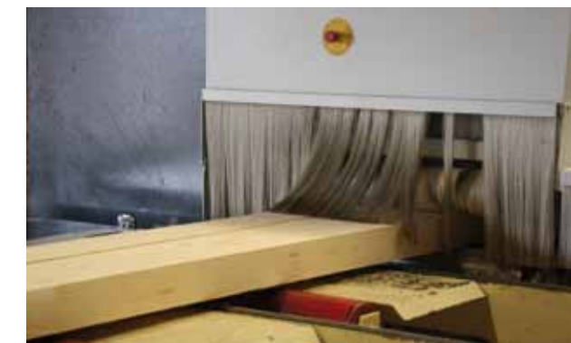
Im Sägewerk stehen moderne Maschinen, wie die Profi-Ripp-Vielblattsäge mit laservorgezeichneter Schnittführung.
